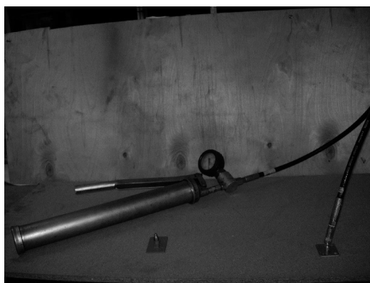
Рисунок 33 - Ручной инъекционный насос с манометром
