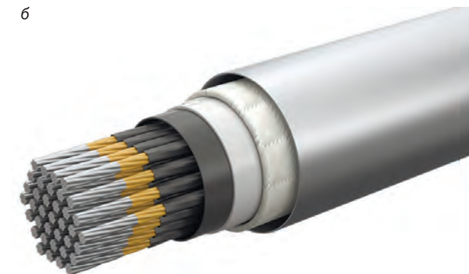
Рис. 1. Конструкция системы огнезащиты вант из стальных прядей: а — зона защиты; б — конструкция системы огнезащиты
