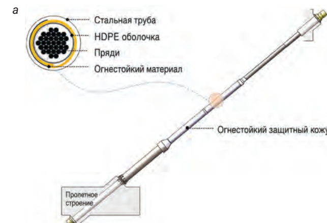
Рис. 1. Конструкция системы огнезащиты вант из стальных прядей: а — зона защиты; б — конструкция системы огнезащиты
