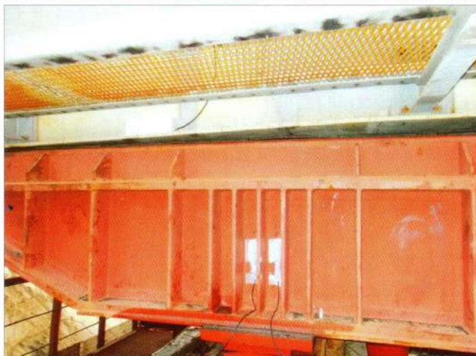
Размещение тензодатчиков на перекатном устройстве
