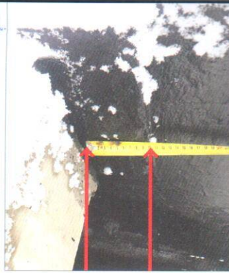
Рис. 6. Положение стенки после смещения отрылка (10 см)
