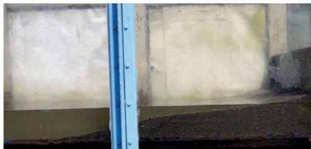
Рис. 5. Профиль пляжа в конце прилива
