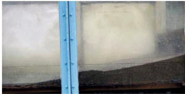
Рис. 4. Профиль пляжа в конце отлива
