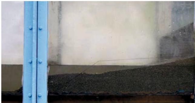
Рис. 3. Профиль динамического равновесия галечного пляжа при максимальном приливе
